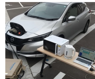
電動車両を用いた電力提供
